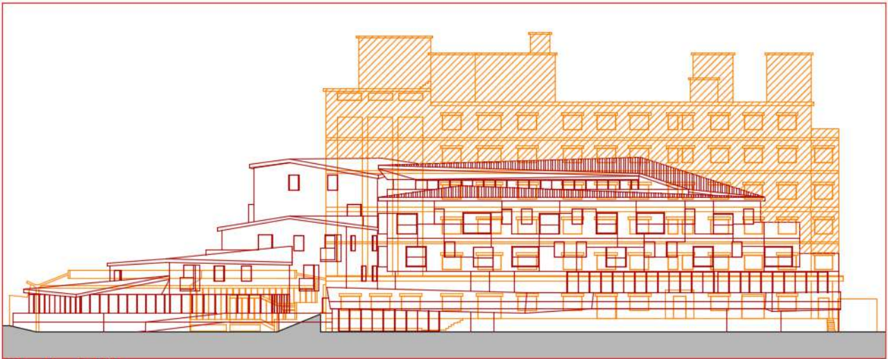
Figura 17- Sovrapposto con stato attuale (in arancio) - sezione trasversale
