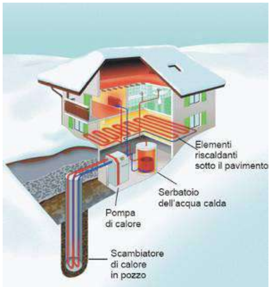
Figura 100 - schema funzionamento pompa geotermica a bassa entalpia
